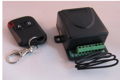
Remote switch med sändarenhet och mottagare. Kabeln som syns på bilden är antenn.
